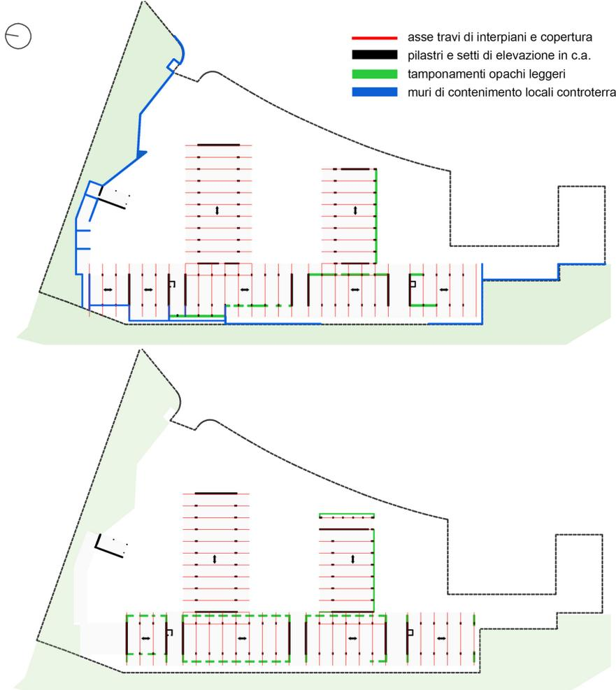
SCHEMA STRUTTURALE E MODULARITA' - PIANO TERRA E PRIMO / COPERTURA
